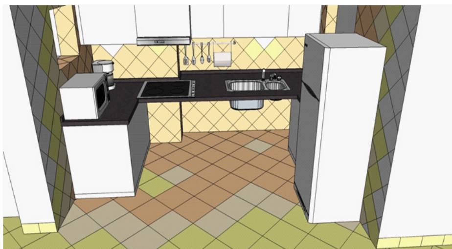
Cozinha – Proposta Final de cozinha adaptada para pessoas com mobilidade reduzida. Destaca-se a disponibilidade de espaço a nível da parte inferior da bancada, aproveitamento máximo dos móveis inferiores laterais e rebaixamento dos móveis superiores de forma a possibilitar igualmente a sua utilização. Objectivo autonomia máxima. Os aparelhos de queima deixam de estar em situação irregular face à actual legislação em vigor
