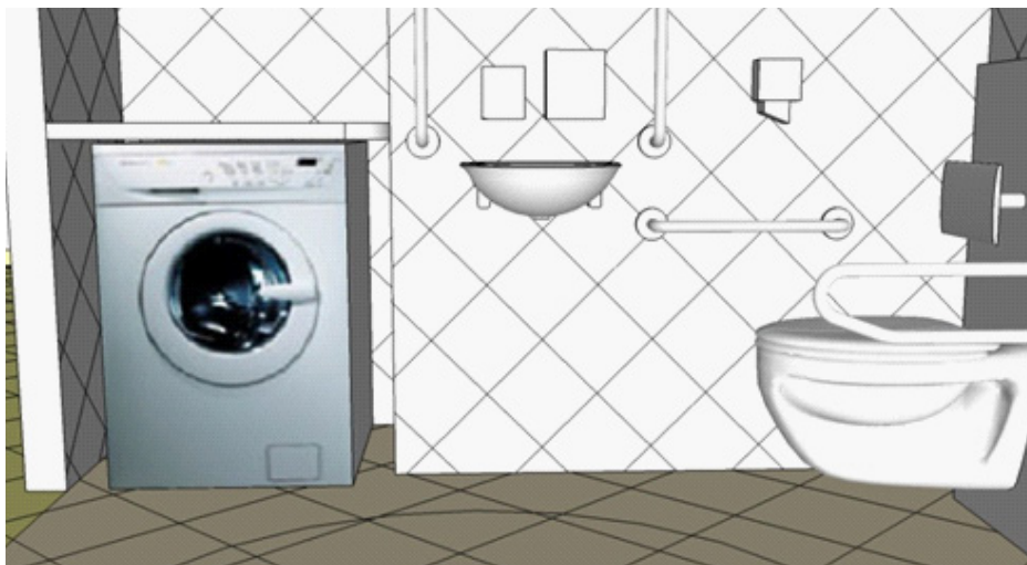
Instalação Sanitária – Proposta Final– Largura I.S. – 2.30m
